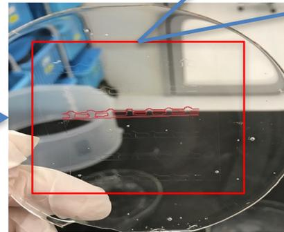
Positive 150 μm PDMS chip mold array
